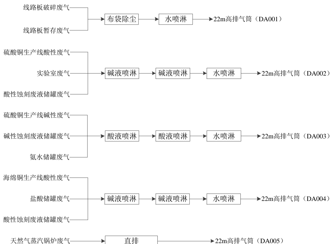
图6.2.1-1 技改后全厂废气污染防治措施示意图
